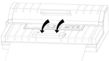
Cierre la tapa y presione firmemente hacia abajo el mango delantero.
