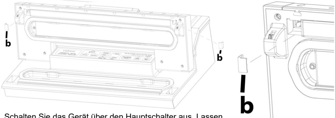
Schalten Sie das Gerät über den Hauptschalter aus. Lassen Sie das Gerät vollständig abkühlen. Öffnen Sie den Deckel des Gerätes. Lösen Sie die Klammern rechts und links (b) des Schweißbalkens vorsichtig mit einem Messer. Hebeln Sie mit einem stumpfen Gegenstand vorsichtig den Schweißbalken heraus
