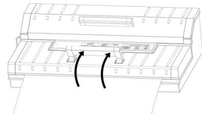
Druk de voorste handgreep weer naar boven, open het deksel en verwijder het zakje. Het zakje kan nu worden gebruikt voor het vacumeren.
