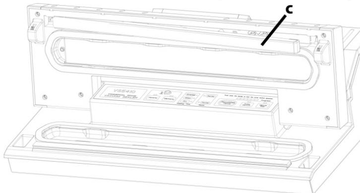
Ziehen Sie den Schweißbalken(c) heraus. Nehmen Sie einen neuen Schweißbalken und pressen Sie diesen in die Mulde im Deckel. Überprüfen Sie den Sitz des Schweißbalkens und setzen Sie die Klammern rechts und links wieder ein.
