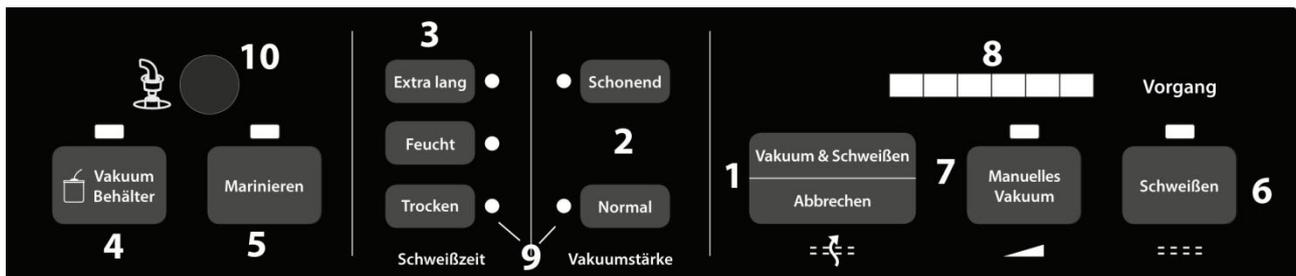
**1 Vacío y sellado/Interrumpir (Vakuum&Schweißen/Abbrechen):** Este botón tiene dos funciones, dependiendo del estado del aparato.
