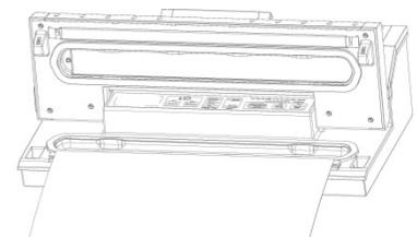
Legen Sie ein Ende des Beutels über die Gummidichtung aber nicht in die Vakuumkammer.
