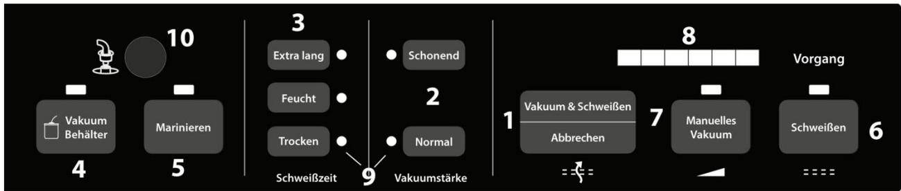
**1 Sotto vuoto e saldatura/Interruzione (Vakuum&Schweißen/Abbrechen):** Questo pulsante ha due funzioni dipendenti dallo stato dell'apparecchio
