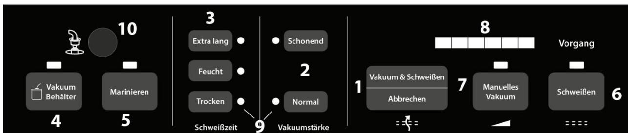
**1 Feu indicateur mettre sous vide et sceller/arrêter****(Vakuum & Schweißen/Abbrechen):**
