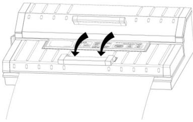
Coloque un extremo de la bolsa sobre la junta de goma, pero no en la cámara de sellado.
