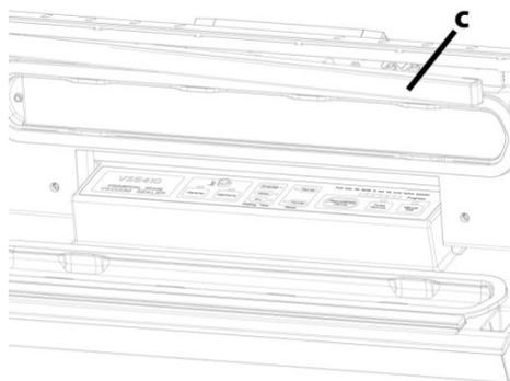
Faites soigneusement levier avec un objet non contondant pour sortir la barre de scellage (c). Retirez la barre de scellage (c). Prenez une barre de scellage neuve et enfoncez-la dans le creux du couvercle. Vérifiez la bonne tenue de la barre de scellage et remettez les crochets de droite et de gauche.
