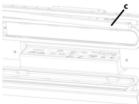
Aprire il coperchio dell'apparecchio. Allentare i fermagli a destra e a sinistra (b) della barra di saldatura (c) cautamente con un coltello. Alzare fuori la barra di saldatura (c) cautamente facendo leva con un oggetto ottuso. Estrarre la barra di saldatura (c).
