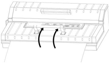
Drücken Sie den vorderen Griff wieder nach oben, öffnen Sie den Deckel und entnehmen Sie den Beutel. Dieser kann nun zum Vakuumieren benutzt werden.
