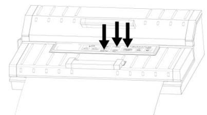
Pulse "Vacío y sellado". (Vakuum&Schweißen) La indicación de progreso LED se iluminará y se aspirará aire automáticamente hasta sellar la bolsa. Si desea interrumpir el proceso (p.ej. porque la bolsa no esté correctamente posicionada), pulse
