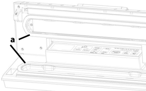
Schalten Sie das Gerät über den Hauptschalter aus. Lassen Sie das Gerät vollständig abkühlen. Öffnen Sie den Deckel des Gerätes. Entfernen Sie die obere/untere Dichtung (a) aus der Mulde im Deckel des Gerätes bzw. aus der Mulde um die Vakuumkammer.
