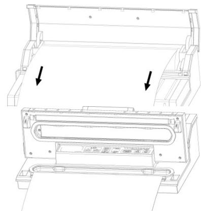
Mettez une extrémité du sachet sur le joint en caoutchouc, mais pas dans la chambre à vide.
